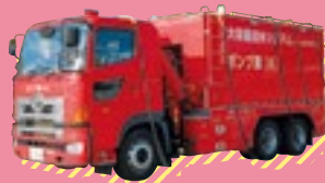
② 取水ポンプ車(車両型)
